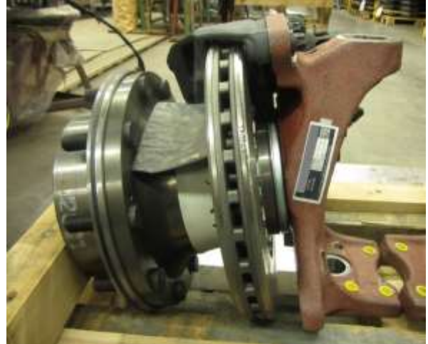
Bild 8: Radseitenausführung mit einem Radplanetengetriebe mit i_{PI} = 4,36 und einer Druckluftscheibenbremse
