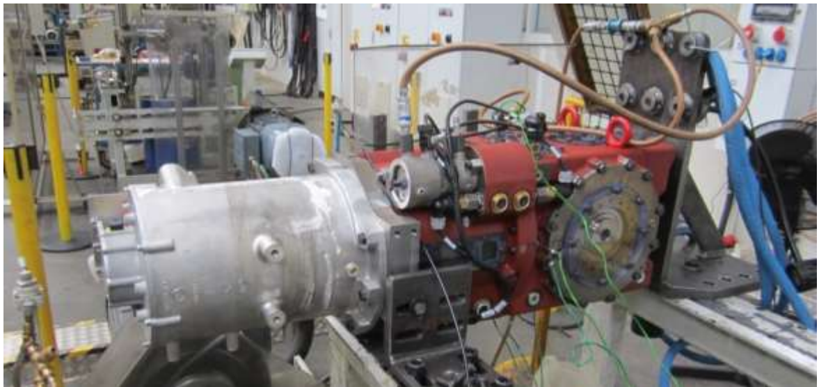
Bild 9: Ausgeführter Antrieb mit Schaltgetriebe und Motor
