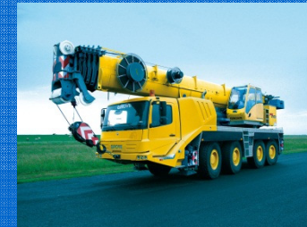
Kran mit Gleitelement im Ausleger und Kunststoffseilrollen
