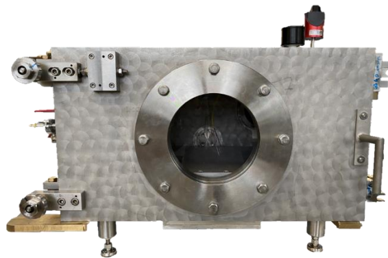
Abbildung 20: Verfahrensraum der modularen Anlage zur mikrowellenunterstützten Gefriertrocknung.
