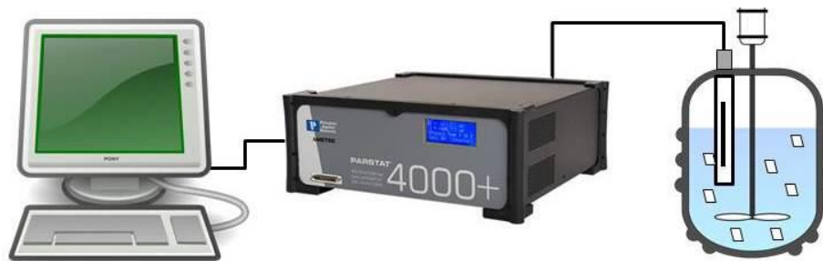
Versuchsaufbau zur Impedanzspektroskopie/Experimental setup for impedance spectroscopy
